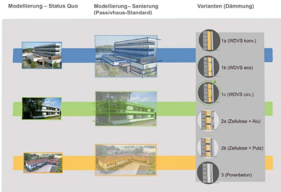
Abbildung 17: Darstellung der Dämmvarianten für die Modellgebäude
